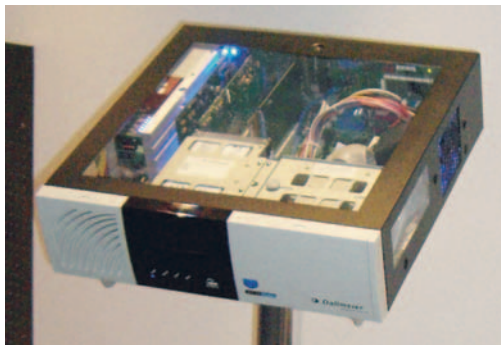
Видеореги­стратор Dallmeier с прозрачной верхней крышкой — рабочий образец для демонстрации в учебном центре. Корпус прибора напоминает по дизайну компоненты high-end аудиосистем. По крайней мере, это непохоже на обычный унылый прибор охранной видеозаписи.
